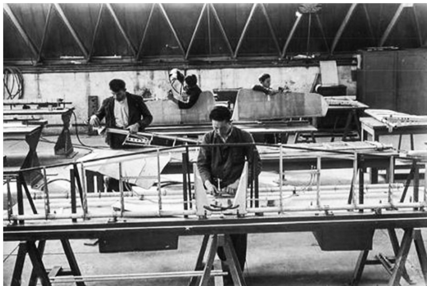
Ilustr. 30. Budowa płatowców PZL P-24. Neslihan Altuncuoğlu, et. al., op. cit., 339.
