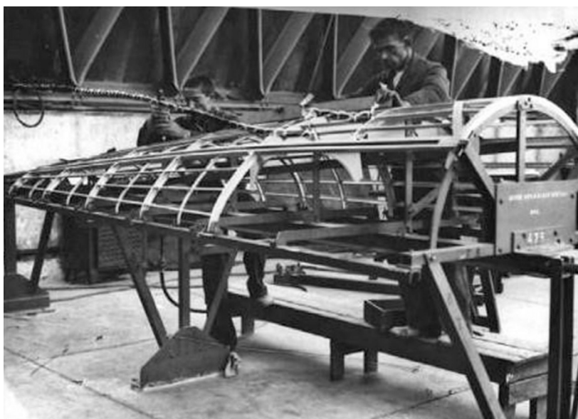
Ilustr. 8. Budowa kadłuba (2'inci HBFM Arşivi [Archiwum Wojskowych Zakładów Lotniczych Nr 2 – przyp. O.F.B.]; N. Altuncuoğlu, H. Özlem Özhan, Y. Hodancı, A. Erdoğan, Tayyare ve Motor Türk , s. 238).
